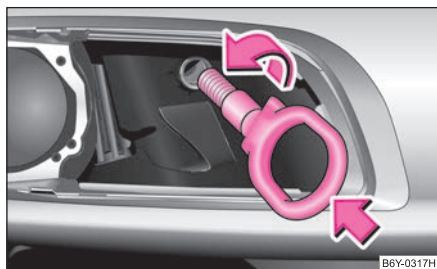
Obr. 163 Přední nárazník: montáž vlečného oka
