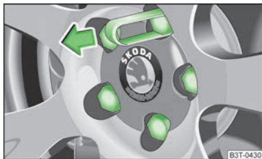
Obr. 143 Stažení krytky šroubu kola
