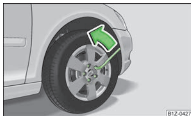
Obr. 148 Výměna kola: povolení šroubů
