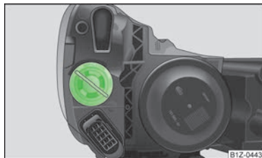
Obr. 161 Demontáž žárovky předního směrového světla
