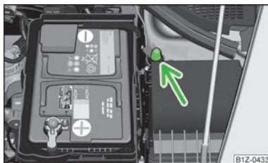
Obr. 154 Pomoc při startování - systém START-STOP
