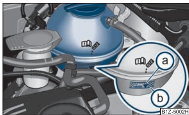
Obr. 124 Motorový prostor: nádržka chladicí kapaliny
